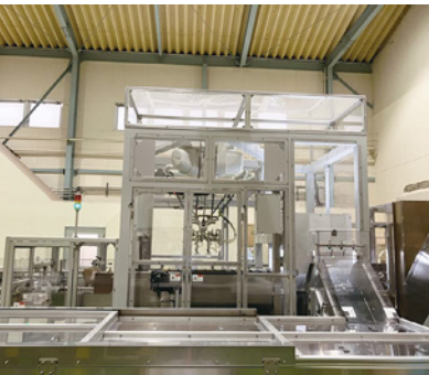
鹿島製油充填工場 産業用ロボットによる空ボトル整列と箱詰め
